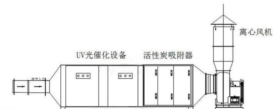
图 7-3 光氧催化活性炭一体机结构示意图
